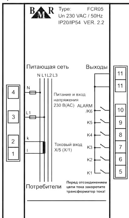
Рисунок 2. Подключение клемм прибору
